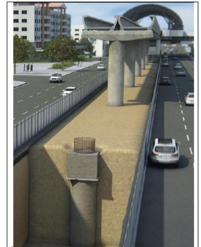
**Fig. 6 – Sección Estructura Viaducto Línea 1**
