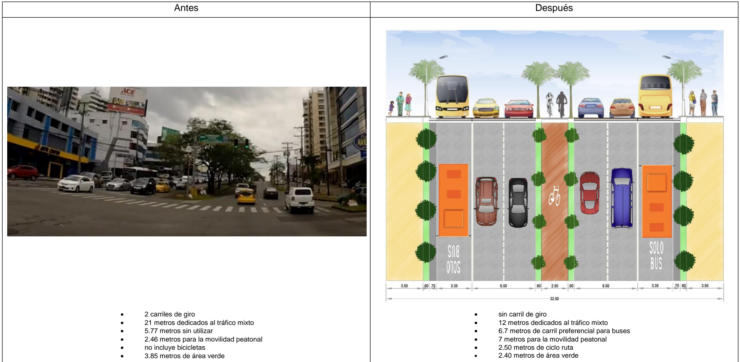
Figura 5-71 Ejemplo de una sección típica posible para Ricardo J. Alfaro entre Calle 74 Oeste y Calle 65 Oeste, El Dorado Corredor Urbano
