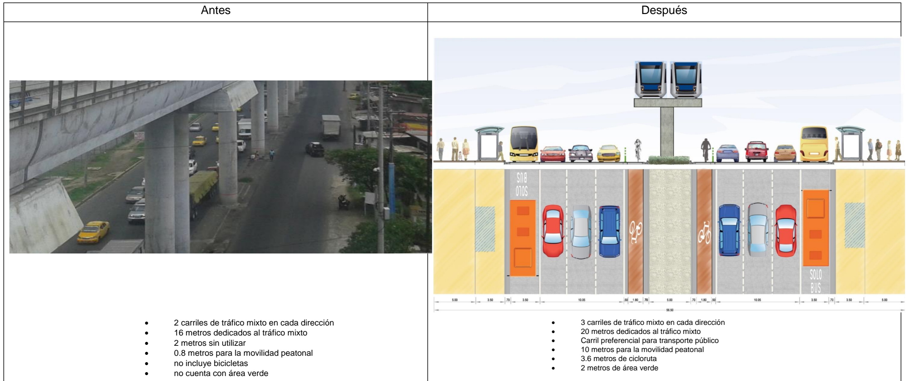
Figura 5-73 Ejemplo de una sección típica posible para Transístmica entre las estaciones de metro de Pueblo Nuevo y Pan de Azúcar, San Miguelito
