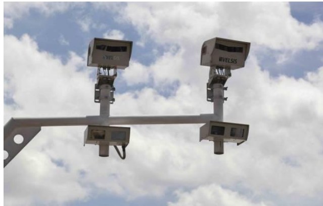
Figura 5-148. Ejemplo de cámaras OCR integradas para un sistema para generación de infracciones
