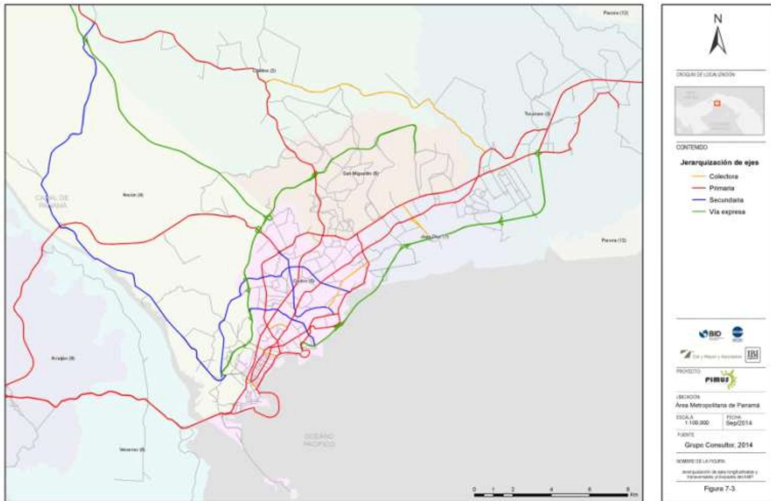
Figura 3-199 Jerarquización de ejes longitudinales y transversales principales del AMP
