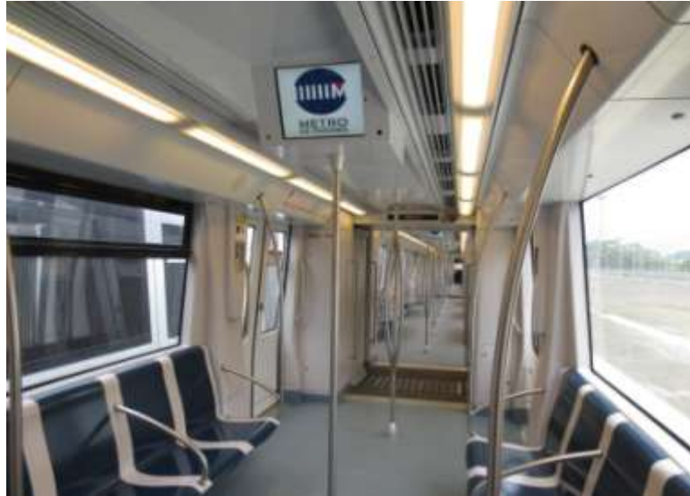
Figura 3-159 Panel multimedia interno en tren.
