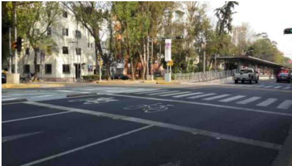
Figura 4-68 Ejemplo de demarcación “caja bici-moto” en Ciudad de México
