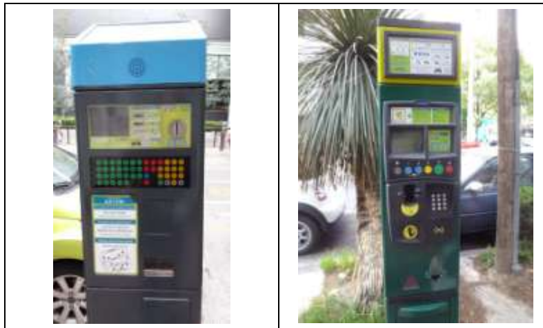
Figura 4-17 Ejemplos de parquímetros de multiespacio
